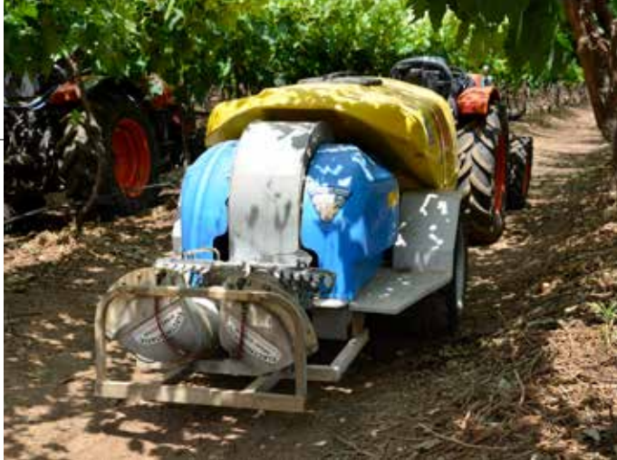
Christoff bespaar op chemikalieë en deur die elektrostatische stelsels waarmee sy spuitwaens toegerus is.
